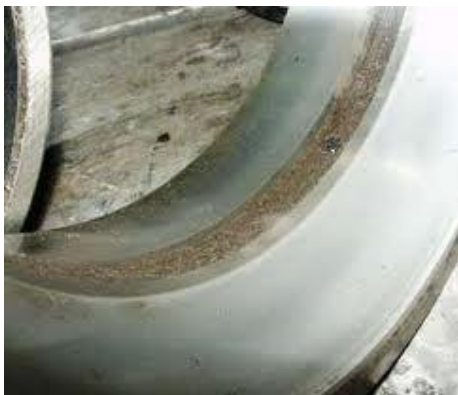
Рис. 1.2 – Окислительный износ внутренней беговой дорожки
