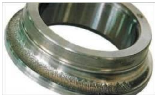
Рис. 1.1 – Контактный износ кольцевой поверхности втулки
