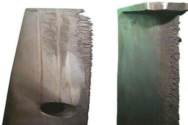
Рис. 1.4 – Эрозионный износ лопаток
