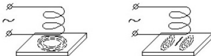
Рис. 5.9 – Схема вихретокового неразрушающего контроля
